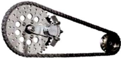
Gambar 7.31. Gear sepeda sebagai contoh roda berporos Sumber : Dokumen Kemdikbud
