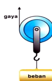
Gambar 7.27. Contoh katrol bebas http://brosibox.blogspot.com
