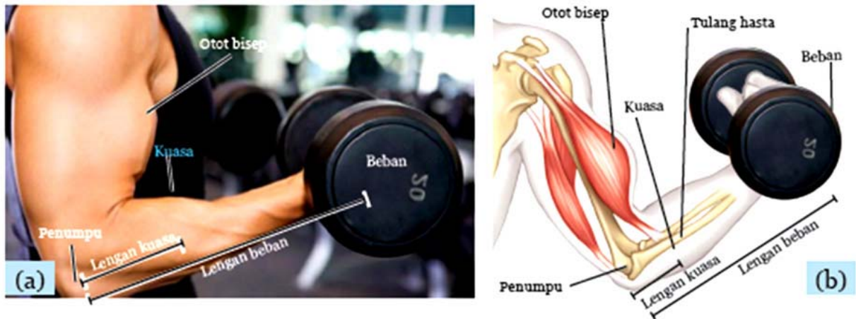
Gambar 7.33. (a) Seseorang mengangkat barbel, (b) Posisi lengan kuasa, lengan beban dan penumpu pada tangan saat mengangkat barbel Sumber : Dok. Kemdikbud
