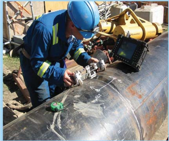
Gambar 24 . pengecekan keretakan logam oleh petugas
