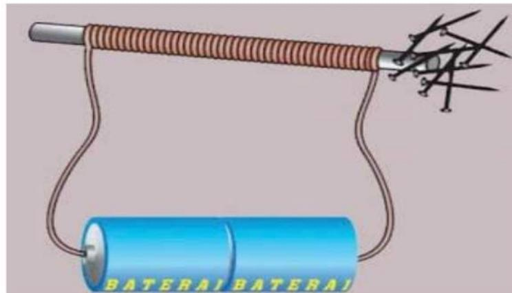
Gambar 15.5. Magnet dengan cara Elektro Magnet
