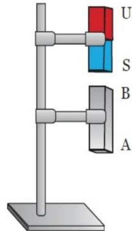
Gambar 15.4. Magnet dengan cara induksi
