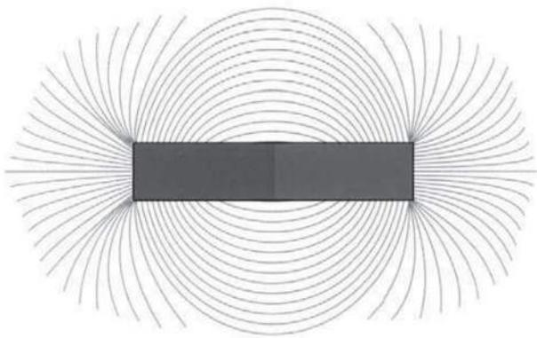
Gambar 15.6. Gaya paling kuat terletak pada kutub magnet
