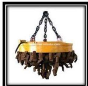
Gambar 15.9. Alat pengangkut besi/baja
