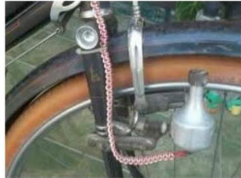
Gambar 14.9. Dinamo Sepeda digunakan untuk menyalakan lampu
