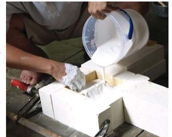
Gambar 23. Pengolahan bahan lunak gips - Sumber: https://www.slideshare.net/ekosupriono1/proses-pembuatan-gypsum
